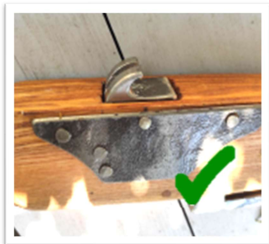
Figura 9 Noce fissata con perno in acciaio, ammesso
