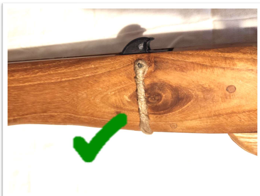
Figura 10 Noce fissata con perno in acciaio occultato da cordino.
