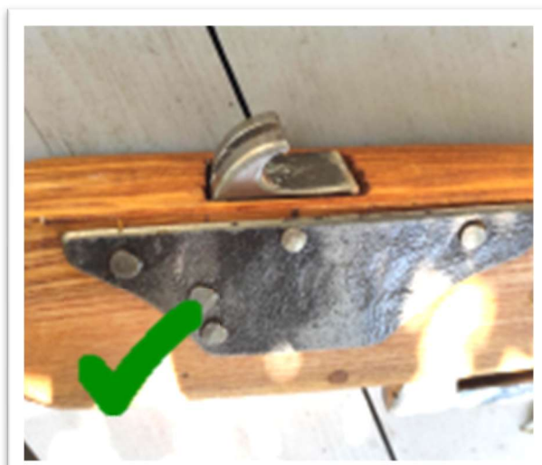
Fig. 9 Noce fissata con perno in acciaio, ammessa
