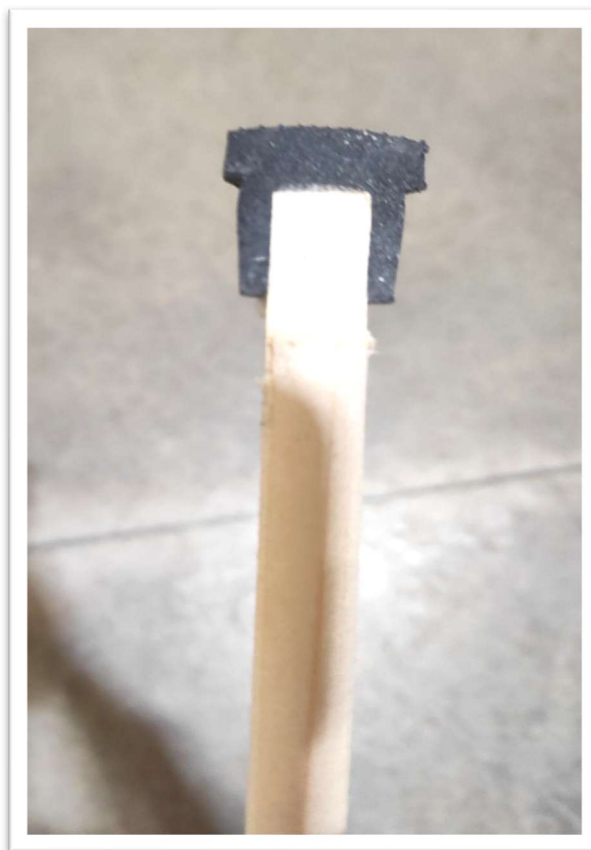
Figura 11 Sezione punta “Blunt”, diametro max esterno 25mm diametro asta 10 mm
