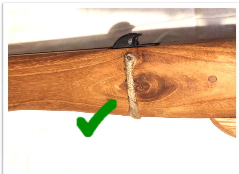
Fig. 10 Noce fissata con perno in acciaio occultato da cordino.
